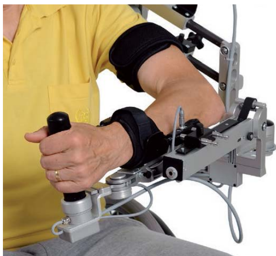
Рисунок 11. Внешний вид Armeo®Power для формирования функции захвата кистью.
