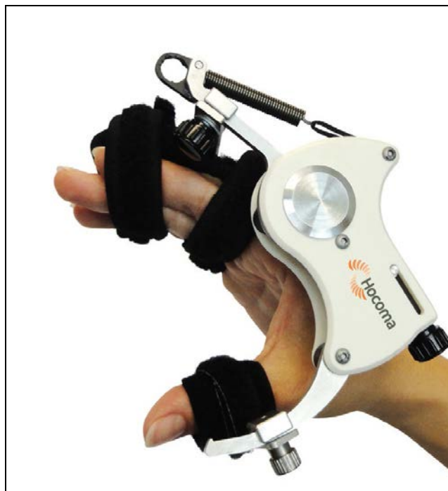
Рисунок 12. Модуль ManovoSpring* для тренировки функциональных движений сжимания и разжимания кисти.
